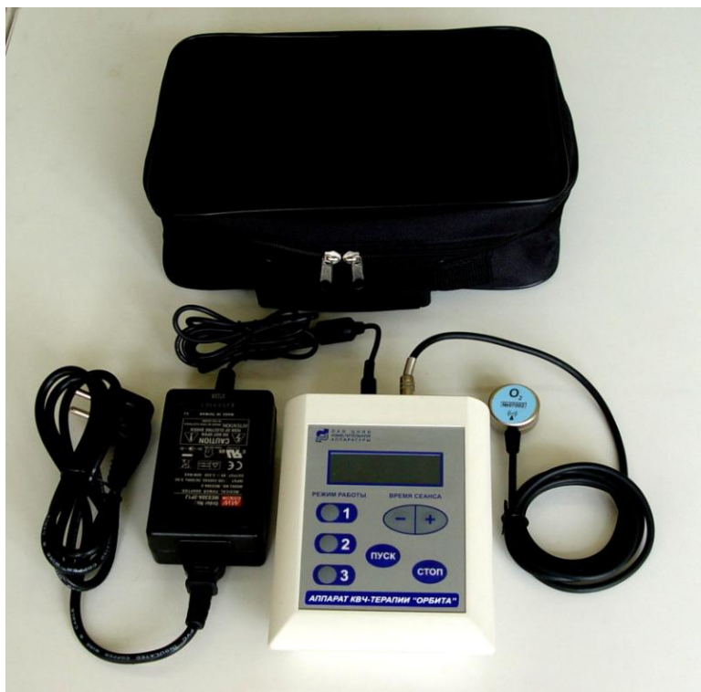
Рисунок 1 – Фотография аппарата КВЧ терапии «ОРБИТА» с подключенным генератором излучателем КВЧ–1
